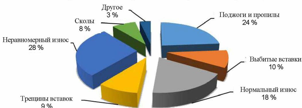
Рисунок 3 – Распределение неисправностей полозов токоприемников
