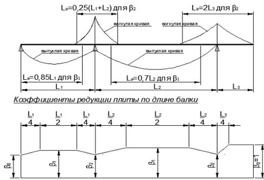
Рис. 2. Значения коэффициентов редуции от положения сечения
