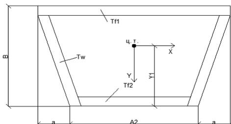
Рис. 5. Расчетное сечение для расчета на кручение
