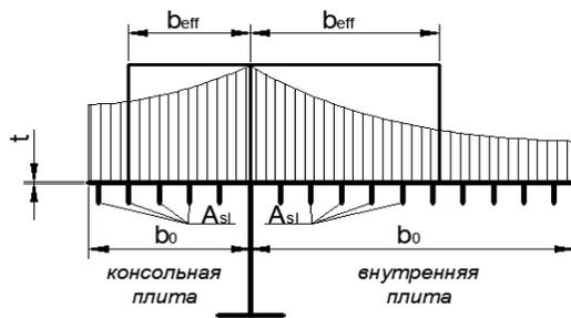
Рис. 3. Расчетная схема
