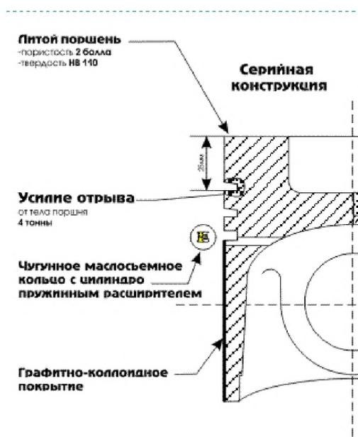
Рисунок 1 – Сечение поршня двигателя КамАЗ
