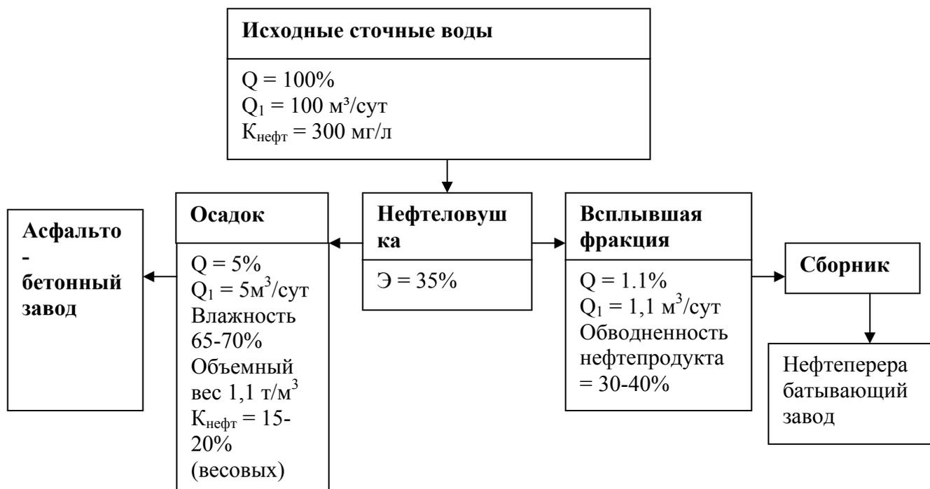
**Рис. 8** Фрагмент качественно-количественной схемы очистки сточных вод на нефтеловушке
