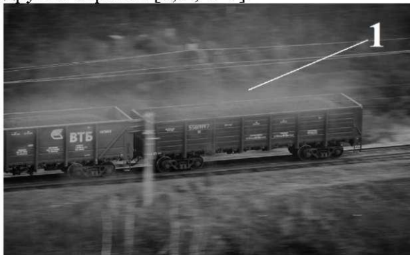
Рис. 1. Снос угольной пыли из полувагонов: 1 – облако пыли.
