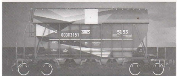
Рис. 2. Вагон-хopper модели 19-5153-01 для перевозки минеральных удобрений со съемной крышей из композиционного материала
