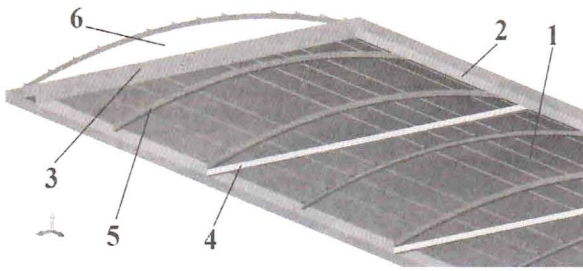
Рис. 4. Геометрическая модель съемной крыши для полувагонов: 1 — обшивка; 2 — боковая продольная балка; 3 — торцевая поперечная балка; 4 — промежуточная поперечная балка; 5 — дуга поперечная; 6 — торцевой лист обшивки
