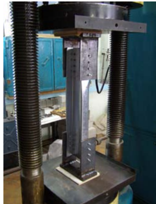
Рис.6.. Характер потери местной устойчивости элементами сечения а) профиль высотой 90 мм; б) профиль высотой 140мм.
