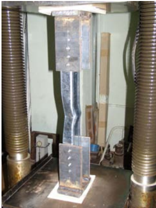
Рис.6.. Характер потери местной устойчивости элементами сечения а) профиль высотой 90 мм; б) профиль высотой 140мм.
