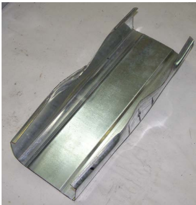
Рис.8. Схема потери местной устойчивости.
