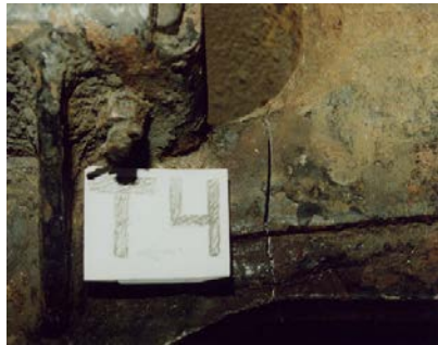
Рис. 2. Трещина в продольной балке рамы тележки, возникшая при проведении вибрационных ресурсных испытаний.
