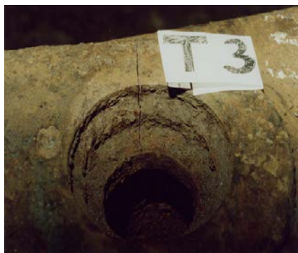
Рис. 3. Трещина в зоне шкворневого узла балки рамы моторной тележки электропоезда ЭР1.
