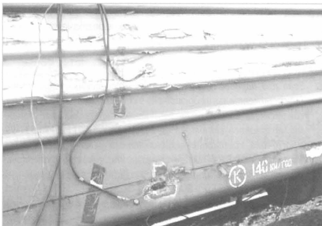
Рис. 1. Розміщення тензодатчиків на кузові вагона
