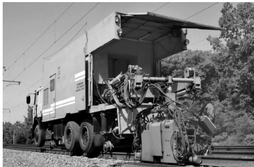
Рис. Комплекс КСМ-005 на шасі МАЗ для контактнього стикового зварювання рейок площею поперечного перерізу від 6500 до 10 000 мм 2 зі зняттям ґрату безпосередньо після зварювання в польових умовах
