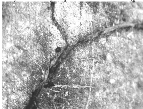
Рисунок 2 – Тріщина з виходом на поверхню кочення колеса повністю заповнена окислами металу. Збільшення 200
