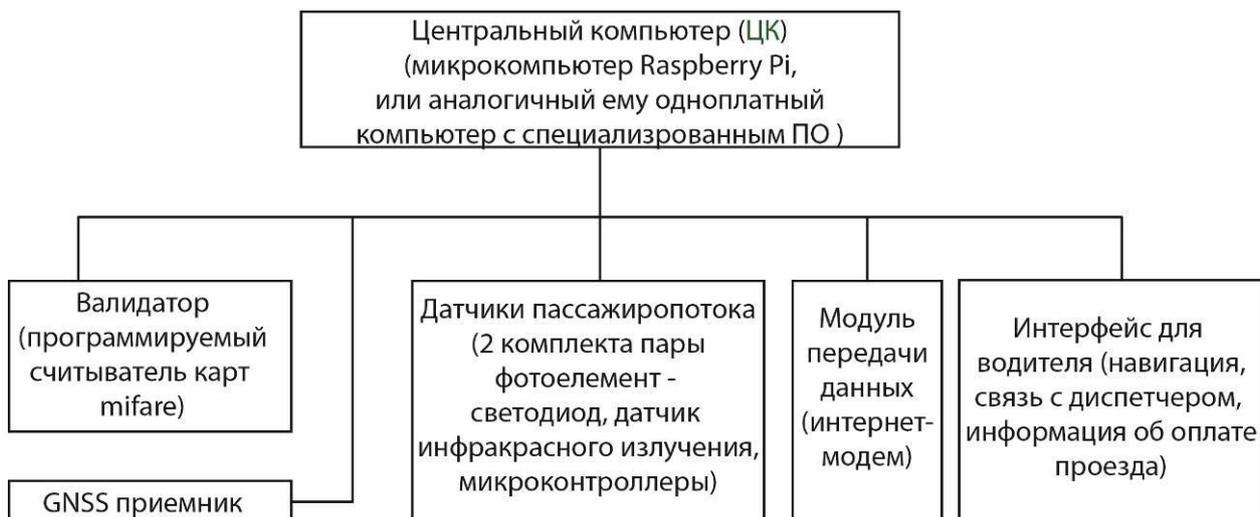
Рис. 3. Структурная схема оборудования, устанавливаемого в транспортных единицах
