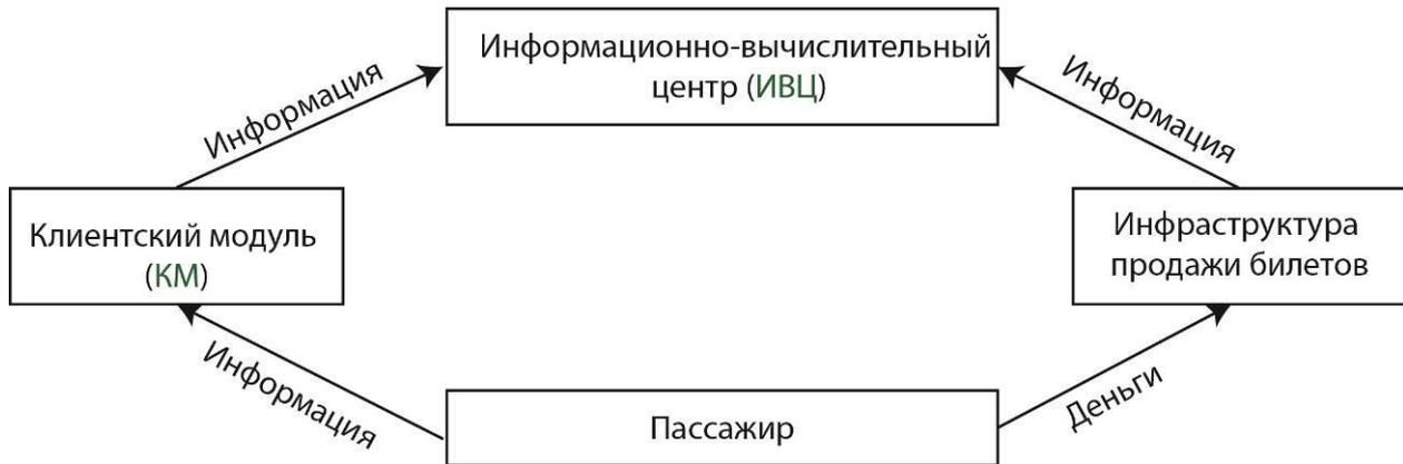
Рис. 2. Упрощенная схема взаимодействий элементов ИТС и её пользователей
