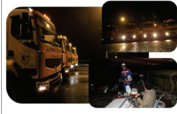
Рис. 2. Експериментальні дослідження мостового переходу через Дніпровську ГЕС (м. Запоріжжя) під навантаженням
