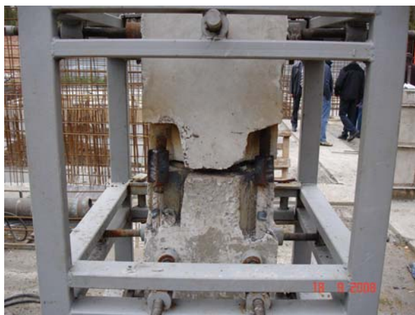
Рис. 2. Узел сочленения сборных колонн
