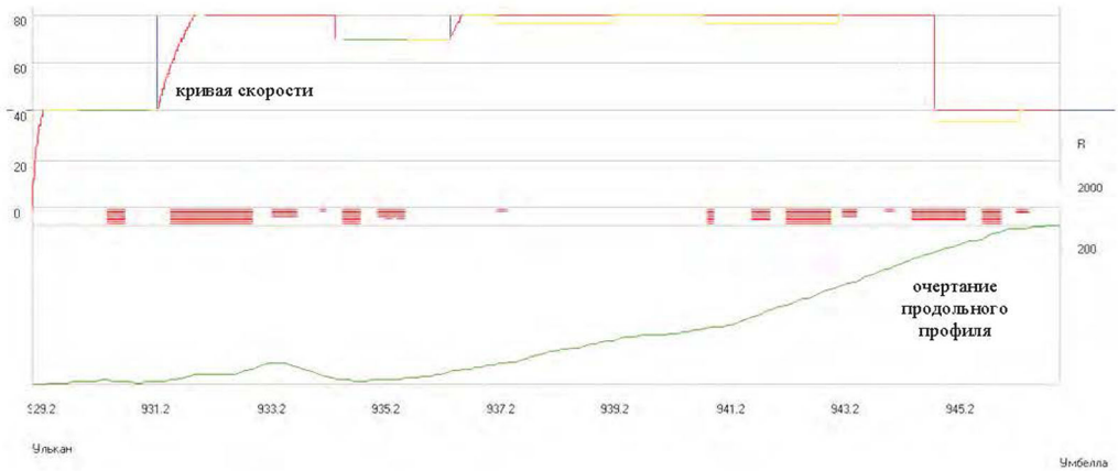
Рис. 2. Очертание продольного профиля (зеленая линия), кривизна пути (красная) и кривая скорости (цвет меняется в зависимости от режима движения, в тяг овом – белая линия)
