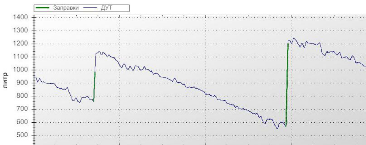
Рисунок 3 – График изменения уровня топлива в баке тепловоза.
