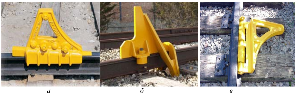
Рис. 2. Тормозные упоры для ограждения путей, используемые на железных дорогах США: а – CS-2 (ALDON Company Inc.); б – CS-4 (ALDON Company Inc.); в – CS-60 (Nolan Company)
