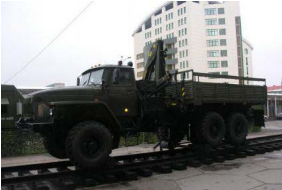
Рис.2 – транспортний засіб на комбінованому рейковому і автомобільному ході на шасі Урал-4320 для транспортування і перевезення матеріалів
