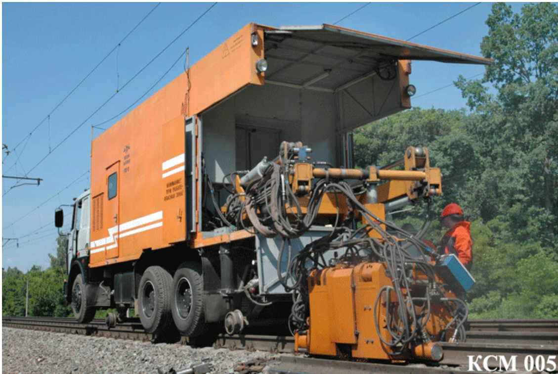
Рис.1 –Комплекс КСМ- 005 на шасі МАЗ для контактнього стикового зварювання рейок площею поперечного перерізу від 6500 мм 2 до 10000 мм 2 зі зняттям ґрату безпосередньо після зварювання у польових умовах
