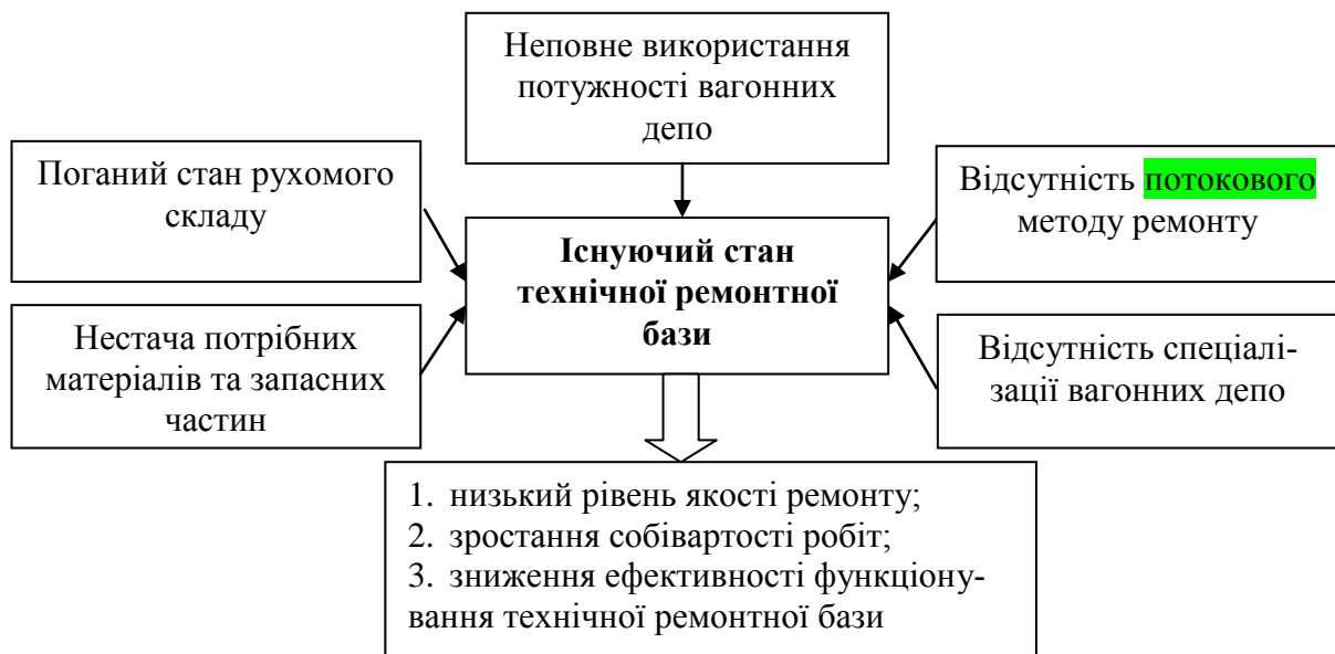
Рисунок 1 – Причини неефективної роботи технічної бази для ремонту вантажних вагонів
