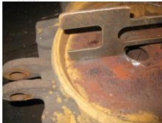
Рисунок 2 – Вимірювання шаблоном зносу підп'ятника вантажного вагону (напіввагону)
