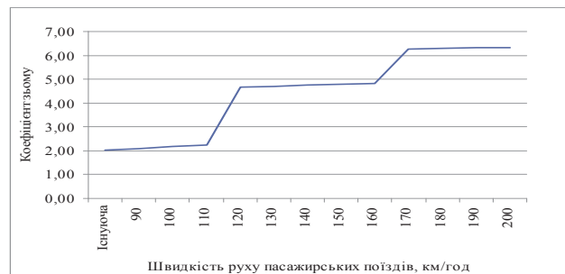
Рис. 1. Загальна діаграма зміни коефіцієнтів зйому вантажних поїздів пасажирськими при постійній дільничній швидкості руху вантажних поїздів 60 км/год та змінній швидкості руху пасажирських поїздів
