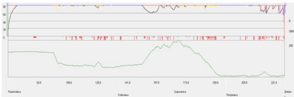
Рисунок 4.11 - Графічні результати тягових розрахунків (знизу доверху: поздовжній профіль, план лінії, крива швидкості руху)
