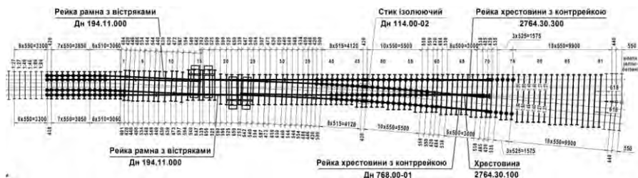
Рис. 7 – Схема вкладання сплетіння типу Р65 марки 1/11 з пересіченням колії 1520 мм колією 1435 мм
