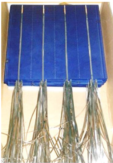
Fig. 1. Підготовлені до пайки фотоелементи
