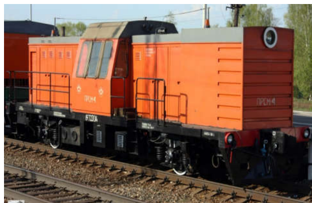
Рис. 2. Пересувна рейкозварювальна машина ПРСМ-4 з контактною електрозварювальною головкою К-900/ Mobile reciprocating machine PRSM-4 with contact electric welding head K-900
