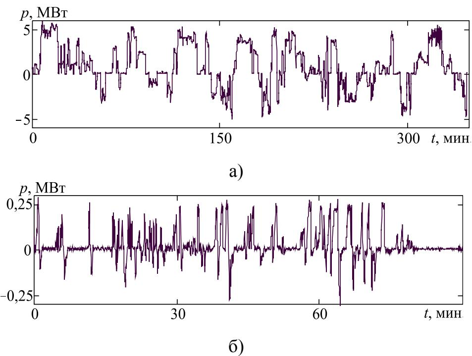
Рис. 1 – Временные диаграммы мощности электровоза ВЛ8 (а) и вагона трамвая ТЗД (б) в одном из режимов работы
