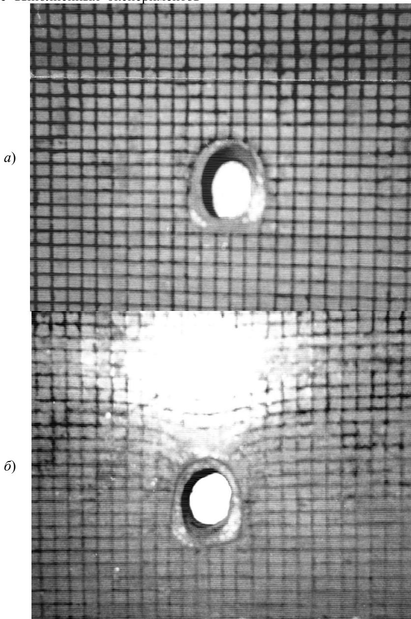
Рис. 2. – Вид модели до эксперимента (a) и после (б)
