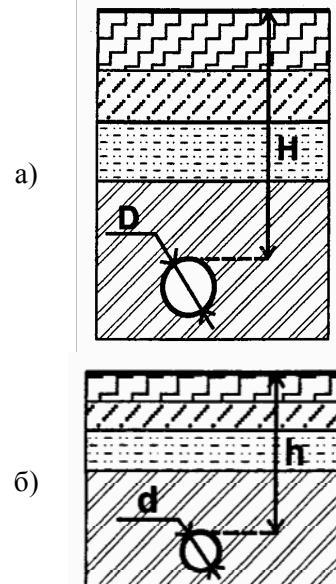
Рис. 1. Схема размещения выработки а) и её модели б) в массиве
