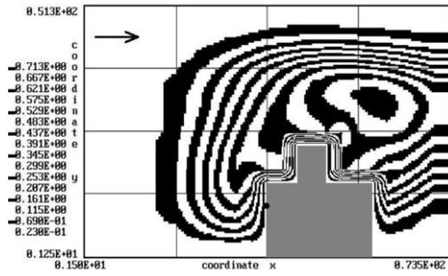
Рис. 5. Зона загрязнения у промышленного здания для момента времени  $t = 5,5$  с. (нет воздушной завесы, сечение  $y = 25$  м)
