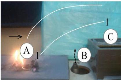
Рис. 4. Зона загрязнения возле модели здания (есть воздушная завеса):
