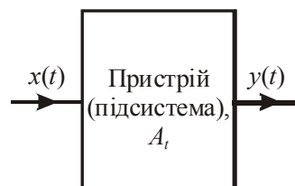
Рис. 8. Пристрій чи підсистема з входною x(t) і вихідною y(t) змінними в часі функціями
