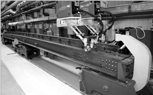
Рисунок 5 – Робототехнічний комплекс для виготовлення хребтової балки для приварювання підсилюючого профілю до хребтової балки
